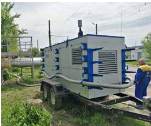
Рис. 2. Применение автономного мобильного опрессовочного центра в Рязани
